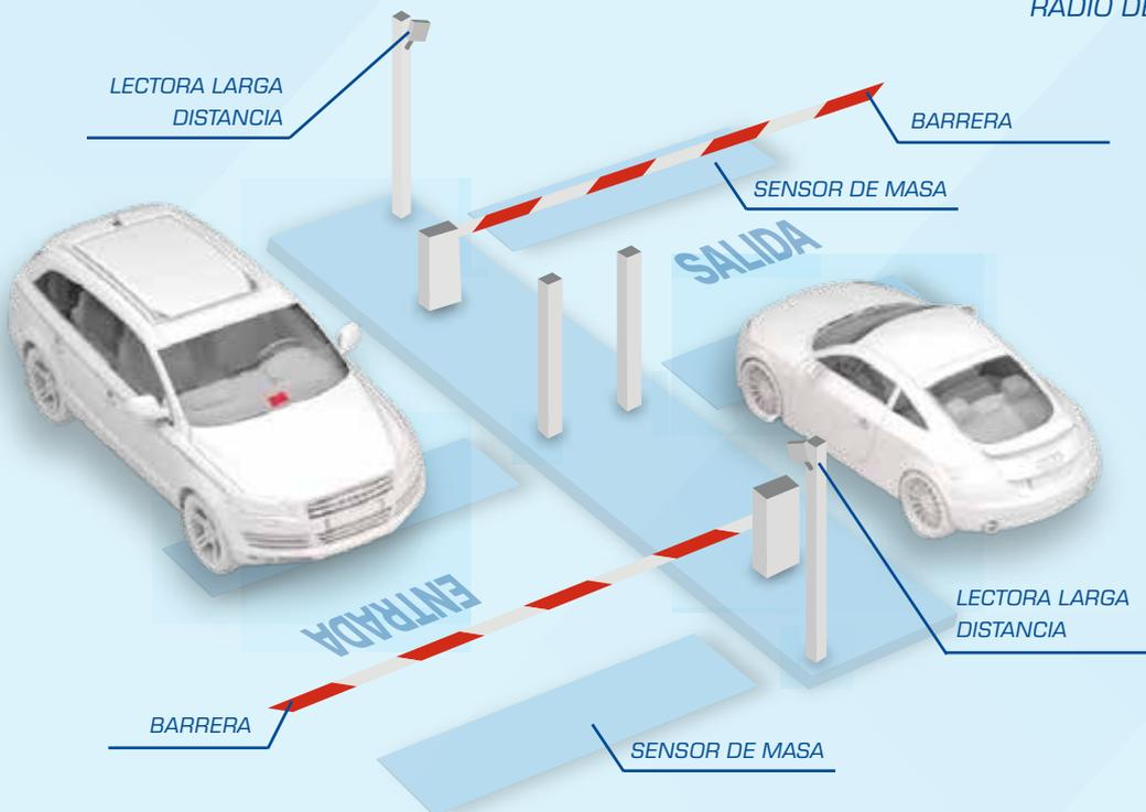
AL ACERCARSE EL VEHICULO AL ACCESO, EL **TAG** EMITE LA INFORMACIÓN A LA **LECTORA DE LARGA DISTANCIA**. LA LECTORA VERIFICA CON EL **PANEL DE CONTROL DE ACCESOS** SI TIENE PERMISO PARA INGRESAR. SI TIENE PERMISO ENTONCES REALIZA LA APERTURA DE LA **BARRERA**. DESPUES DEL PASO DEL VEHÍCULO, EL **SENSOR DE MASA** REALIZA EL CIERRE AUTOMÁTICO, SI EL VEHICULO PERMANECE DEBAJO ESTA NO SE CERRARÁ.
